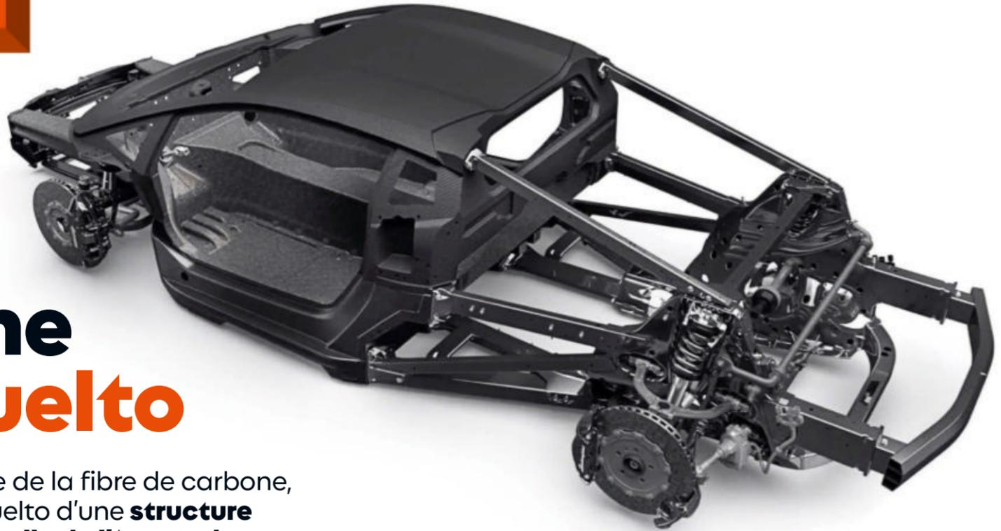
Grâce à une utilisation étendue de la fibre de carbone, Lamborghini a pu doter la Revuelto d'une **structure plus rigide et plus légère que celle de l'Aventador.**
