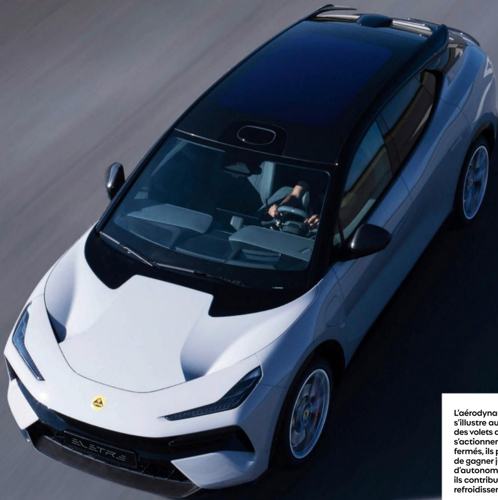
L'aérodynamique active s'illustre aussi à l'avant avec des volets automatiques qui s'actionnent selon la situation : fermés, ils permettent de gagner jusqu'à 15 km d'autonomie ; ouverts, ils contribuent au refroidissement du moteur.
